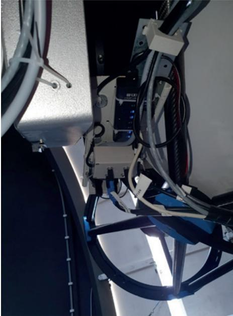
12) Vue de l'alimentation en 12V des différents appareils sur le télescope.
